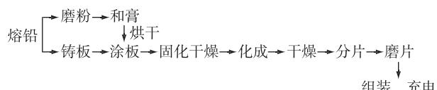
图 1 某铅酸蓄电池企业生产工艺流程图
